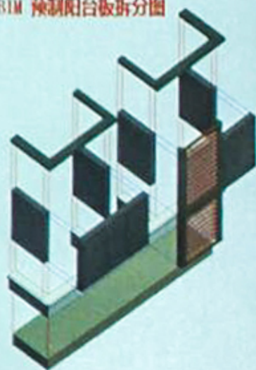
BIM 预制阳台板拆分图
