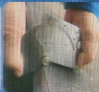
坡口角度检查
