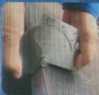
坡口角度检查
