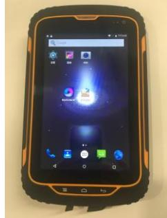
智能眼镜通过主控平板开热点自组网，主控平板保存视频。等巡检完毕，再上传视频到存储服务器
